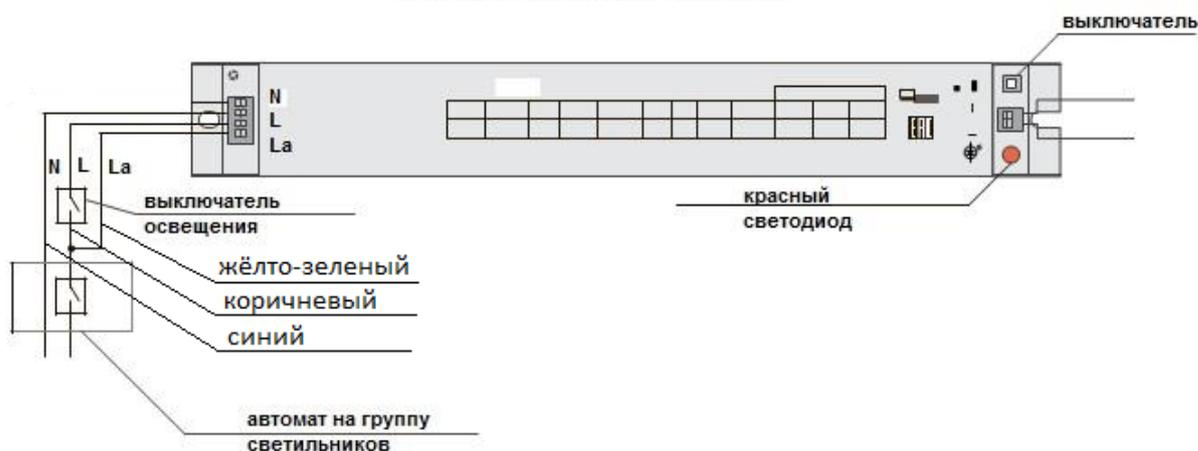
3. Подключите к источнику питания сетевые провода, соблюдая обозначения на БАП.
